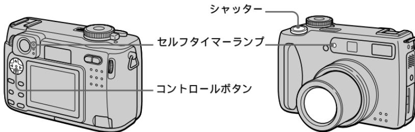
メニューを消し(40ページ)、コントロールボタンの▼(⌚)を押したあと、シャッターを深く押し込みます。画面に⌚セルフタイマーが表示され、シャッターを押してから約10秒後に撮影されます。その間、セルフタイマーランプが点滅し、ピッピッピとビープ音が鳴ります。セルフタイマーを途中で止めるには、もう一度コントロールボタンの▼(⌚)を押します。
