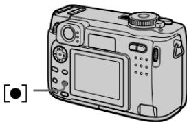
[●]ボタンで全体測光、スポット測光の切り換えをする。
