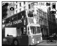
露出を + 方向に補正するとヒストグラムは右側にずれる
