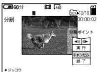
分割する位置を微調整したいときは、[◀/▶]/[◀/▶] (コマ送り/コマ戻し) を選び、◀/▶で微調整します。
