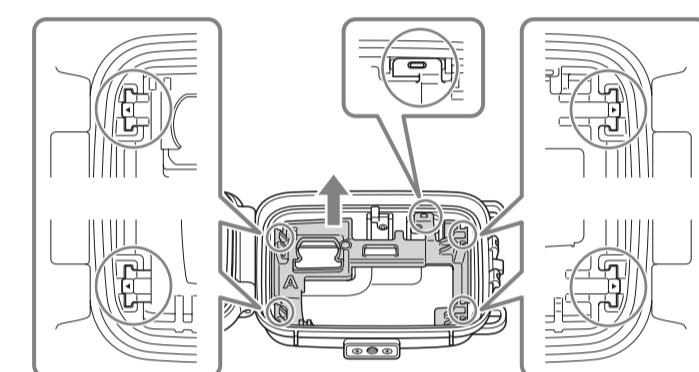
図の○印部分を持って、垂直に引き上げる
