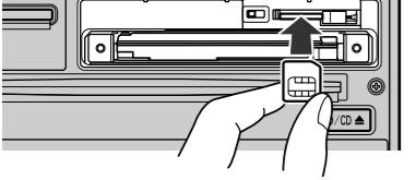
3 フロントパネルのボタン周辺の照明が消灯していることを確認後、認証カードを挿入部へ入れる。
