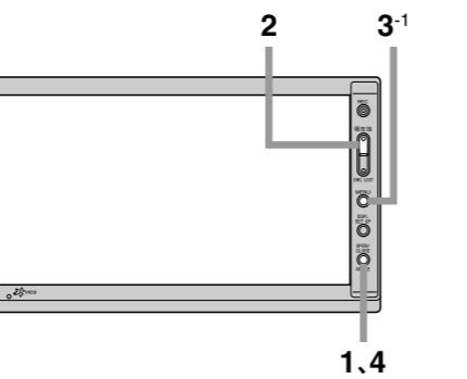
1 車のイグニッションスイッチを「ACC」または「ON」にし、パネルの [OPEN/CLOSE] ボタンを押してディスプレイを閉じ、地図画面が表示されることを確認する。
