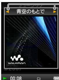
ジャケット写真画面の表示中に◀/▶ボタンで曲送りや曲戻しができます。
