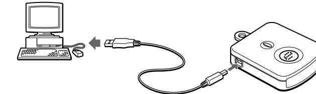
「eMarker」をコンピュータに接続すると、本体に入っているeMarkデータはコンピュータに自動的に送信されます。この時点で、本体のeMarkデータは空になります。
