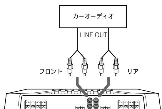
D ラインインプット接続(スピーカーの接続②の場合)
