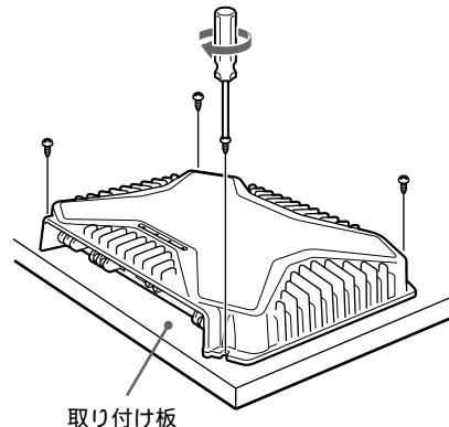
本機を取り付け板にあて取り付け位置を決め、穴の位置に印をつけます。次に、印をつけたところに直径3 mm以内の穴をあけ、付属のビスを使って本機を取り付け板に固定します。
