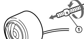
取り付ける側の厚みに最適な長さの止めねじ
