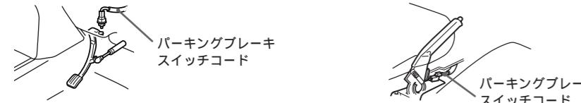
安全のため、前座席用のケーブルに接続したモニターの映像は、停車中にパーキングブレーキを引いた状態でなければ出力されません。
