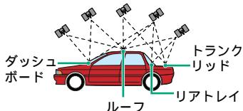
車内に取り付けるときはリアトレイやダッシュボードの平らな位置にアンテナが水平になるように取り付けてください。車内に適する場所がない場合は、車外に取り付けてください。
