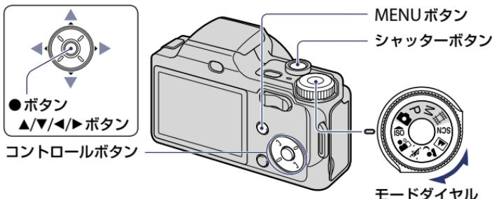
モードダイヤルにあるモード( $\text{iso}$ / $\text{P}$ / $\text{A}$ / $\text{S}$ / $\text{M}$ )を選ぶ
