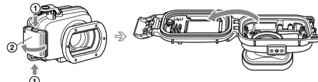
上下のOPENボタンを同時に押しながら①、バックルを矢印②の方向にはし、マリンパックのボディを開く。
