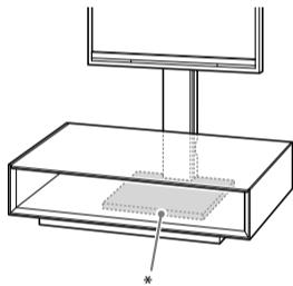
図のように、フロアスタンド(SU-FL71シリーズ)の台座\*をまたいで設置してください。その際、フロアスタンドが台座にぶつからず傷などがつかないよう十分ご注意ください。
