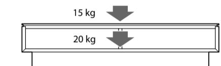
図に示す質量以上のものを載せないでください。指定の質量を超えると、ガラス板や底板が割れることがあります。
