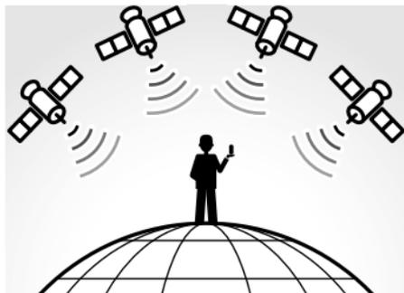
位置を計算することを「測位」と呼び、衛星は3機受信できれば、緯度、経度がわかります。
