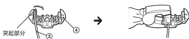
2. 圧着式コネクター④を車両側パーキングブレーキスイッチコードの適当な位置に取り付ける。
