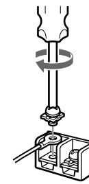
ネジを傷めないよう、締め付けトルクは1N·m以下で締め付けてください。
