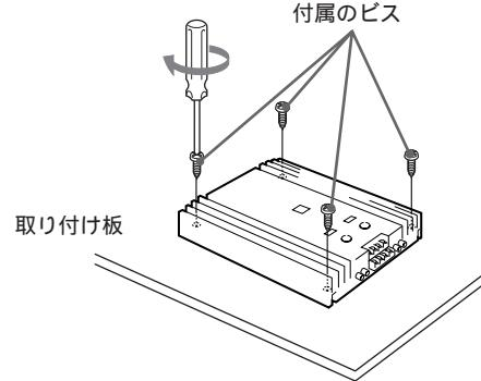
本機を取り付け板にあて取り付け位置を決め、穴の位置に印をつけます。次に、印をつけたところに直径3mm以内の穴をあけ、付属のビスを使って本機を取り付け板に固定します。
