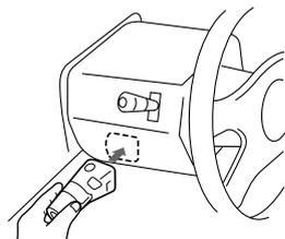
ごみや油などが表面に付着していると、両面テープの接着力が低下します。
