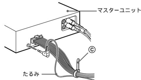
接続後、コマンダーのプラグが抜けないように、コードにたるみをつけ、付属のクランパー◎で他の接続コードと一緒に束ねてください。
