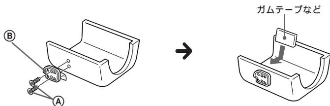
ネジを締めたあと、コラムカバー裏側に飛び出したネジの先端をガムテープなどで覆い、コード類の損傷を防止してください。
