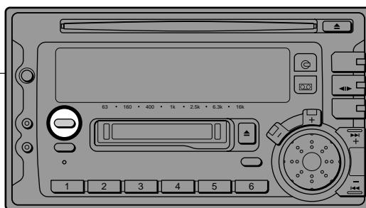
刻々と変化する音声信号レベルを13バンドのスペクトラムアナライザーでリアルタイムに表示します。また、表示パターンは9種類の中から選ぶことができます。
