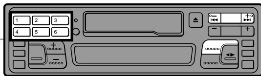
放送局を自動プリセット(8ページ)したあと、空いている数字ボタンに他の放送局を追加登録できます。すでにプリセットしてある数字ボタンも、他の放送局に登録し直すことができます。道路交通情報(AM 1,620kHzまたはAM 1,629kHz)をプリセットしておくと便利です。
