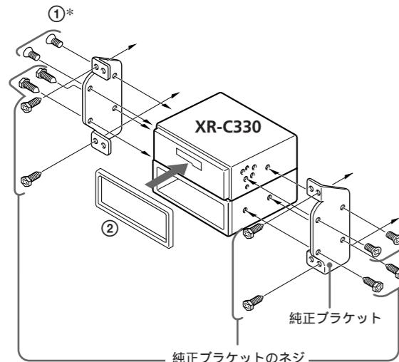
\*付属の皿ネジ①で取り付けてください。他のネジを使用すると故障の原因となります。
