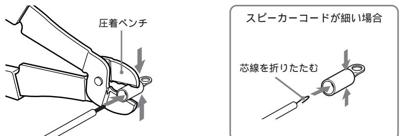
使用するスピーカーコードが細く圧着端子の内径に余裕がある場合、芯線を折りたたんで太さを調節してから圧着ペンチでしっかりとしめてください。
