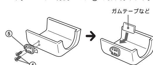
ネジを締めたあと、コラムカバー裏側に飛び出したネジの先端をガムテープなどで覆い、コード類の損傷を防止してください。
