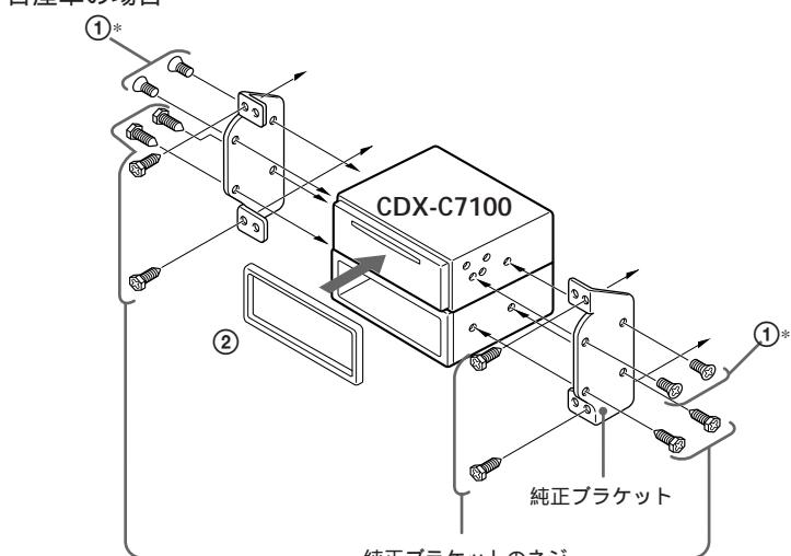
\* 付属の皿ネジ①で取り付けてください。他のネジを使用すると故障の原因になります。
