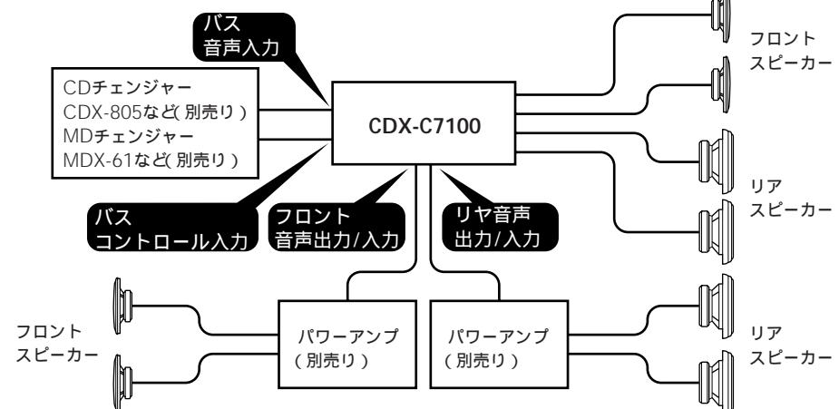
接続例4 音声出力/入力切り換えスイッチを②の位置にして下さい。
