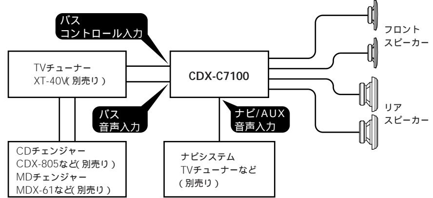
接続例3 音声出力/入力切り換えスイッチを①の位置にして下さい。
