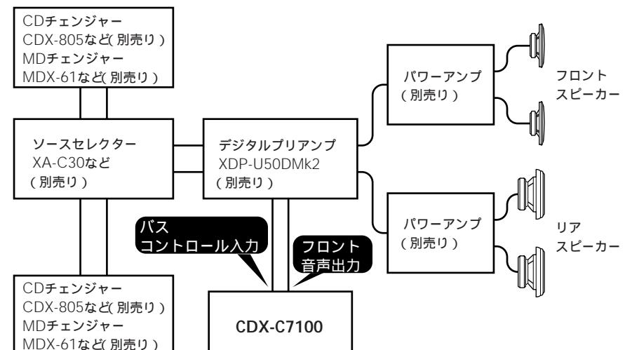
接続例5 音声出力/入力切り換えスイッチを①の位置にして下さい。
