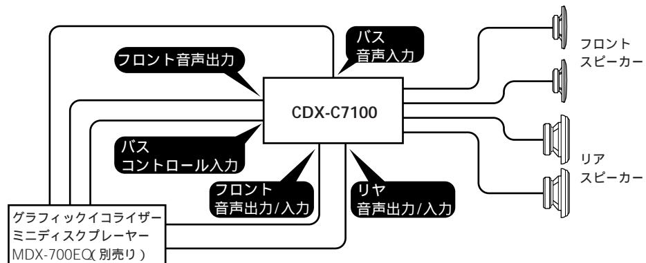
接続例2 音声出力/入力切り換えスイッチを①の位置にして下さい。
