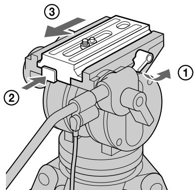
業務用ビデオカメラ(DSR-200など)を三脚アダプターを使って取り付ける場合は、三脚から3/8インチカメラネジを取りはずす。
