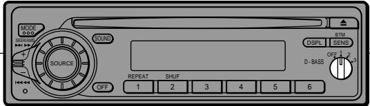
D-BASS機能(ダイナミックベース)は低音域をシャープに増幅するため、従来の低音強調機能よりも同じ音量でクリアな力強い低音を楽しめます。さらにデジタルD-BASS<sup>\*</sup>では、独自のICを採用し、アナログD-BASSを超えた迫力ある重低音で再生します。
