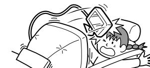
運転操作や車体の可動部を妨げないように取り付ける
