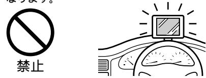
**助手席用エアバッグシステムの動作を妨げないように取り付ける**
