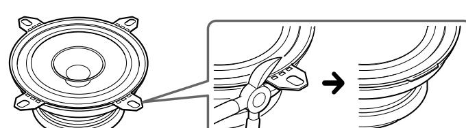
スピーカーの取り付けサイズは、取り付けタブをカットすることで、他の同サイズの車にも対応します。
