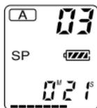
2 用件の再生中にファイル(FILE)ボタンを押して、移動先のファイルを点滅させる。移動先のファイルと「MOVE」表示が点滅し、用件の頭の5秒と最後の5秒が10回繰り返し再生されます。
