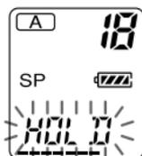
操作できるようにするには、ホールド(HOLD)スイッチを矢印と反対の方向にずらしてください。
