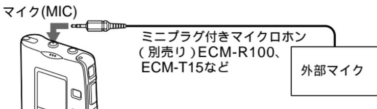
外部マイクをつなぐと、内蔵マイクは自動的に切れ、外部マイクの音を録音します。プラグインパワー対応のマイクを使うと、マイクの電源は本機から供給されます。
