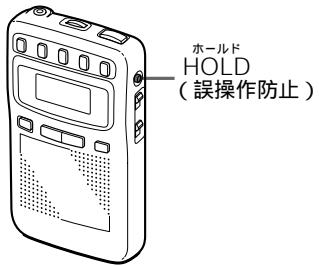
電源が入っているときにHOLDボタンを押して表示窓に「
