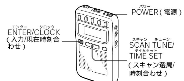
1 POWERボタンを押して、ラジオの電源を切る。
