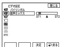
お買い上げ時はステレオ1のみの音声が出るように設定されています。メニューでバランスを調整しても、電源をはずして5分たつとバランスはステレオ1のみの音が出る設定に戻ります。
