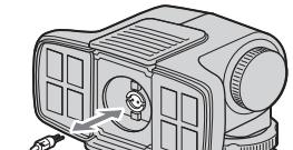
3 反射板の穴にランプが入るよう にして、フロント窓をまっすぐ に取り付ける。
