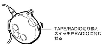
TAPE/RADIO切り換えスイッチをRADIOに合わせる
