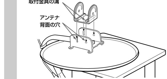
2 二つの穴と溝にボルト（アンテナ取付金具用）を差し込み、ナットを取り付ける。
