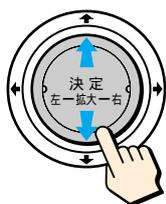
ソニー製BSデジタルチューナーのリモコンのチャンネル+/- ボタンと同じようにチューナーのチャンネルを選べます。
