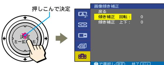
5 ▲/▼で「傾き補正 回転」または「傾き補正 上下」を選び、真ん中を押し込んで決定する。
