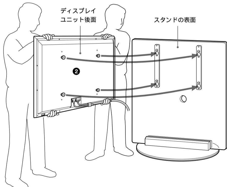
② 金具の4か所の穴にディスプレイユニット後面のフックが完全にはまつたことを確認してから、ディスプレイユニットをガチャッと音がするまでまっすぐ下におろす。
