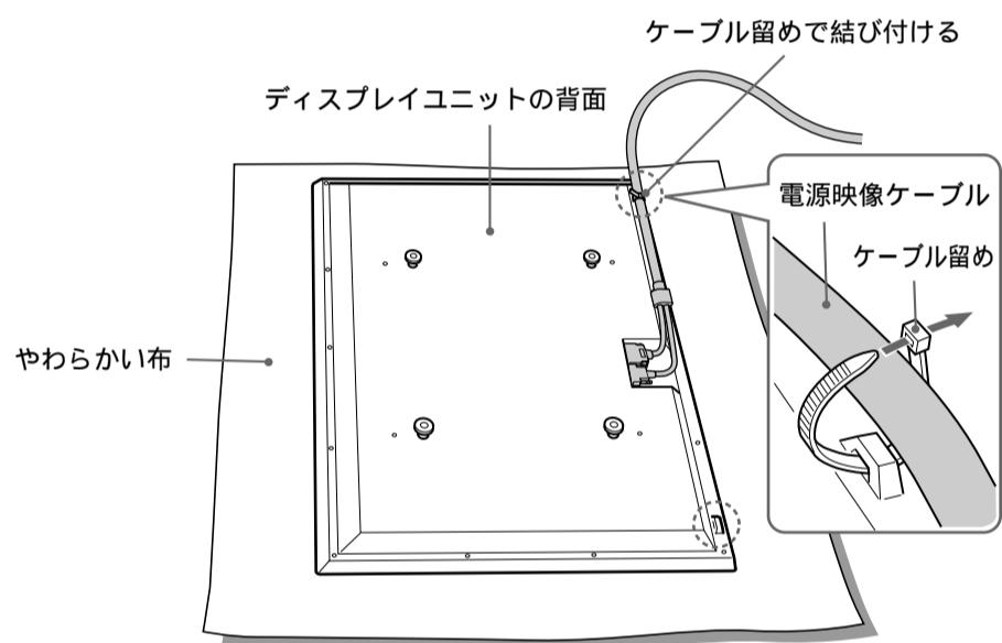
ディスプレイユニットに付属のケーブル留めをディスプレイユニット後面の通し穴に通して、電源映像ケーブルを結び付けます。通し穴は左右2か所ありますので、どちらか都合の良いほうを使ってください。
