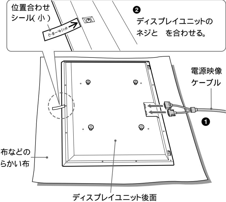
※ 電源映像ケーブルをディスプレイユニットの後面に固定するには
