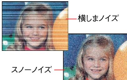
電波妨害や接触不良が起きています。アンテナ線が端子にキチンとつながっているか、折れたり切れたりしていないか確認してください。
