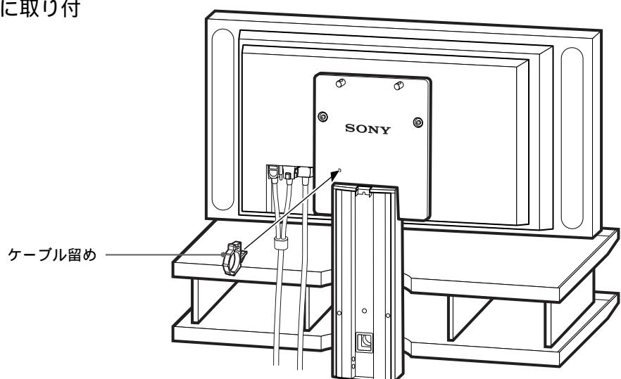
② ケーブル留めに電源コードおよびディスプレイケーブルを通して、コード類を留める。
