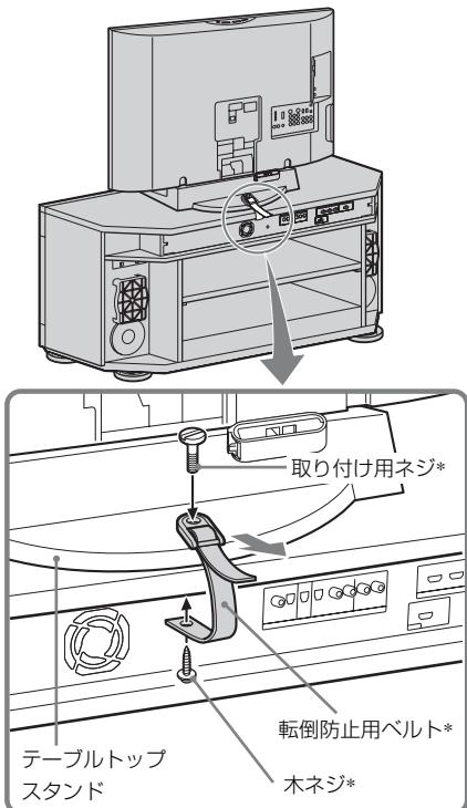
\* 転倒防止用ベルト、木ネジ、取り付け用ネジはソニー製液晶テレビに付属されています。
