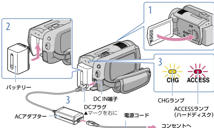
専用の“インフォリチウム”バッテリー（Hシリーズ）を本機に取り付けて充電します。
