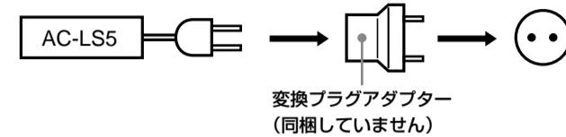
本機を海外旅行者用の電子式変圧器(トラベルコンバーター)に接続しないでください。発熱や故障の原因となります。
