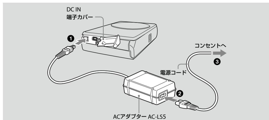
① デジタルスチルカメラのDC IN端子カバーを開け、ACアダプターをデジタルスチルカメラのDC IN端子につなぐ。
