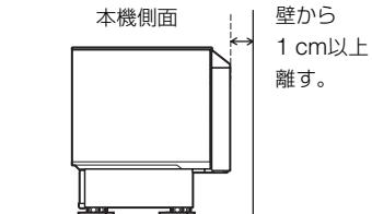
本機は部屋のコーナーに設置しやすいように、後部を斜めに仕上げてあります。部屋のコーナーに設置する場合、コーナーから本機前面まで約87 cmの距離が必要です。
