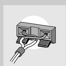
スピーカーコードの先端が端子から大幅にはみ出し、他のコードと接触している。
