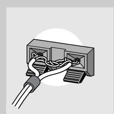
スピーカーコードの先端が他のコードと接触している。
