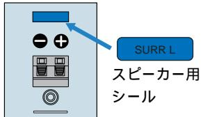
付属のスピーカー用シール(5色、FRONT Lなど)を、スピーカー底面/後面の端子の近くに1枚ずつ貼ってください。
