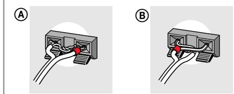
Ⓐ スピーカーコードの先端が他のコードと接触している。
