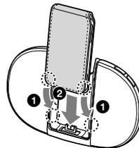
図のように、ケースを取り付けた“ウォークマン”をソフトケース用スピーカーアタッチメントの内側にあわせて①の方向に入れ、②のように下方向へスライドさせてスピーカーにセットする
