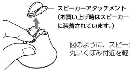
図のように、スピーカーアタッチメントの丸いぼみ付近を軽く押して取りはずす
