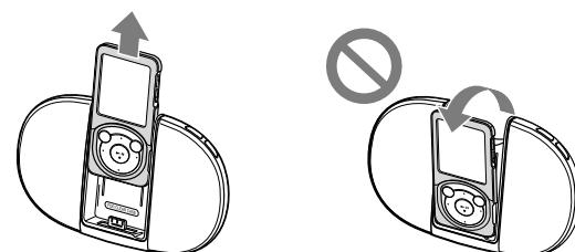
ケースを取り付けた“ウォークマン”を上方向へスライドさせて取りはずしてください。“ウォークマン”を手前に傾けるような力を加えないでください。コネクターを破損することがあります。
