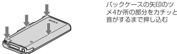
バックケースの矢印のツメ4か所の部分をカチッと音がするまで押し込む
