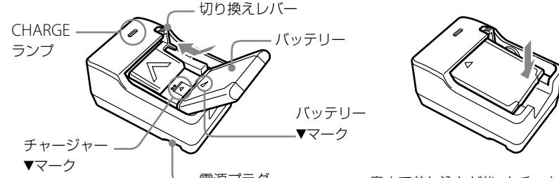
バッテリーの▼マークを本機の▼マークの方向に合わせて、矢印の方向に差し込んでください。
