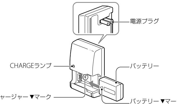
バッテリーの▼マークを本機の▼マークの方向に合わせて、矢印方向にカチッと音がするまでスライドさせてください。
