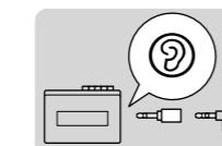
モノラルの機器につなぐときは、別売のプラグアダプター PC-236MSを使用すると左右のスピーカーから音が出るようになります。
